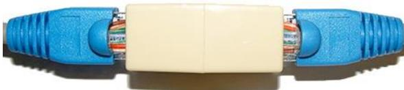
Der gleiche RJ45-Verbinder dient dazu, die blauen RJ45-Anschlüsse zu verbinden, die für alle *Sensor-zu-Alarm-*Verbindungen verwendet werden.
