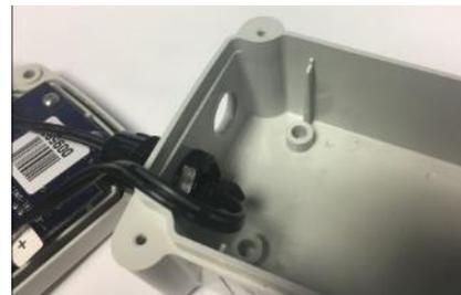
**4] Einen Durchführungs-Steckschieber über dem Loch anbringen, aus dem die Durchführung und das Kabel entfernt wurden.**
