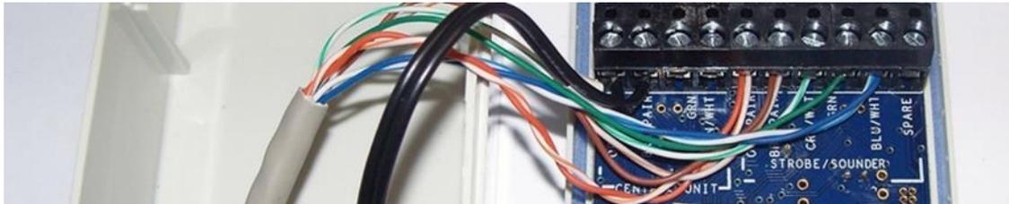
**2] Die folgenden Kabel von dem 10-poligen Schraubklemmen trennen, dabei die zwei schwarzen Kabel (Netzteil) an Ort und Stelle lassen.**
